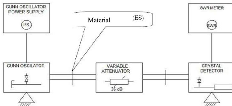
**Figure 11.** Schema bloc pentru determinarile experimentale
