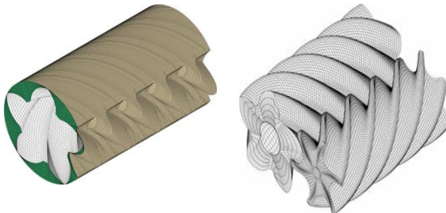
Figura 1. Camerele de lucru ale compresorului
